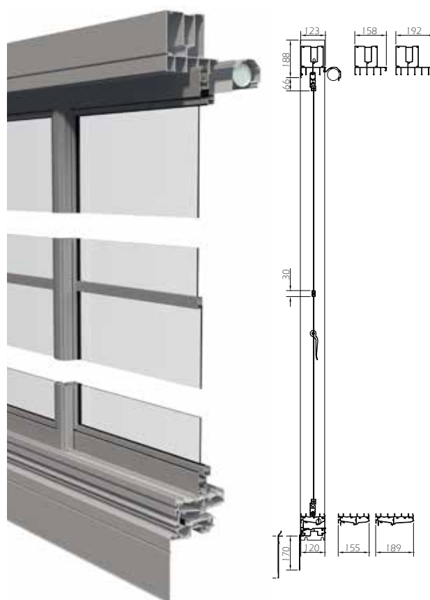
Twin våningshög. Tvärsnitt och ritning från sidan.
