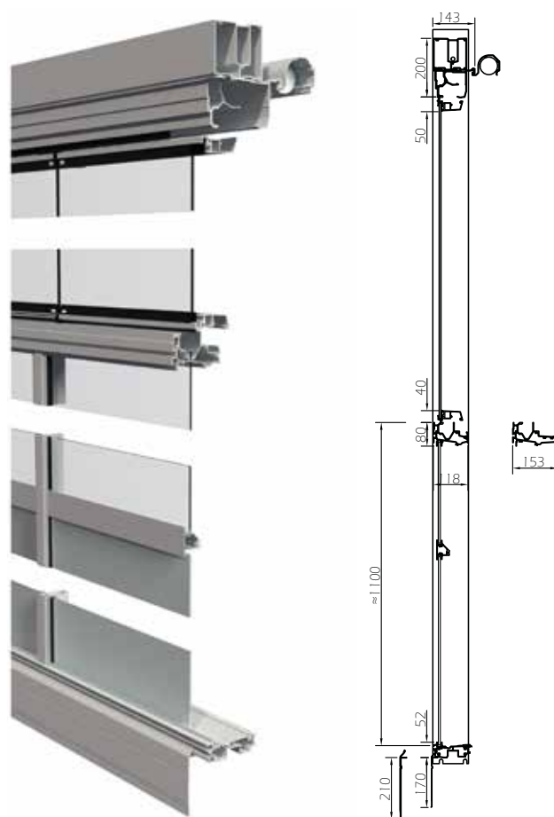
Design Sight. Tvärsnitt och ritning från sidan.
